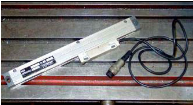
4.16. ábra. Üvegskálás -kódoló (beépítés előtt)
