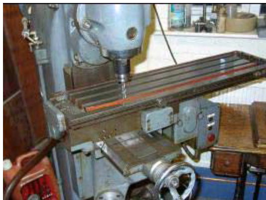
4.10. ábra. Maró X=0, Y=0 pozícióban lévő szerszámmal
