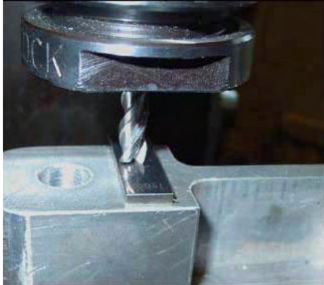
7.10. ábra. Z eltolás meghatározása mérőhasáb érintésével marógépen
